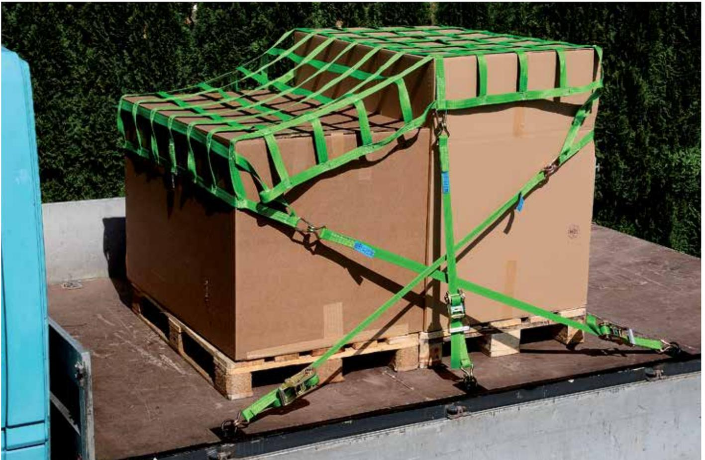
Das Bandnetz dieser Abbildung ist eine Sonderanfertigung und damit nicht nach DIN EN-Norm gelistet.
