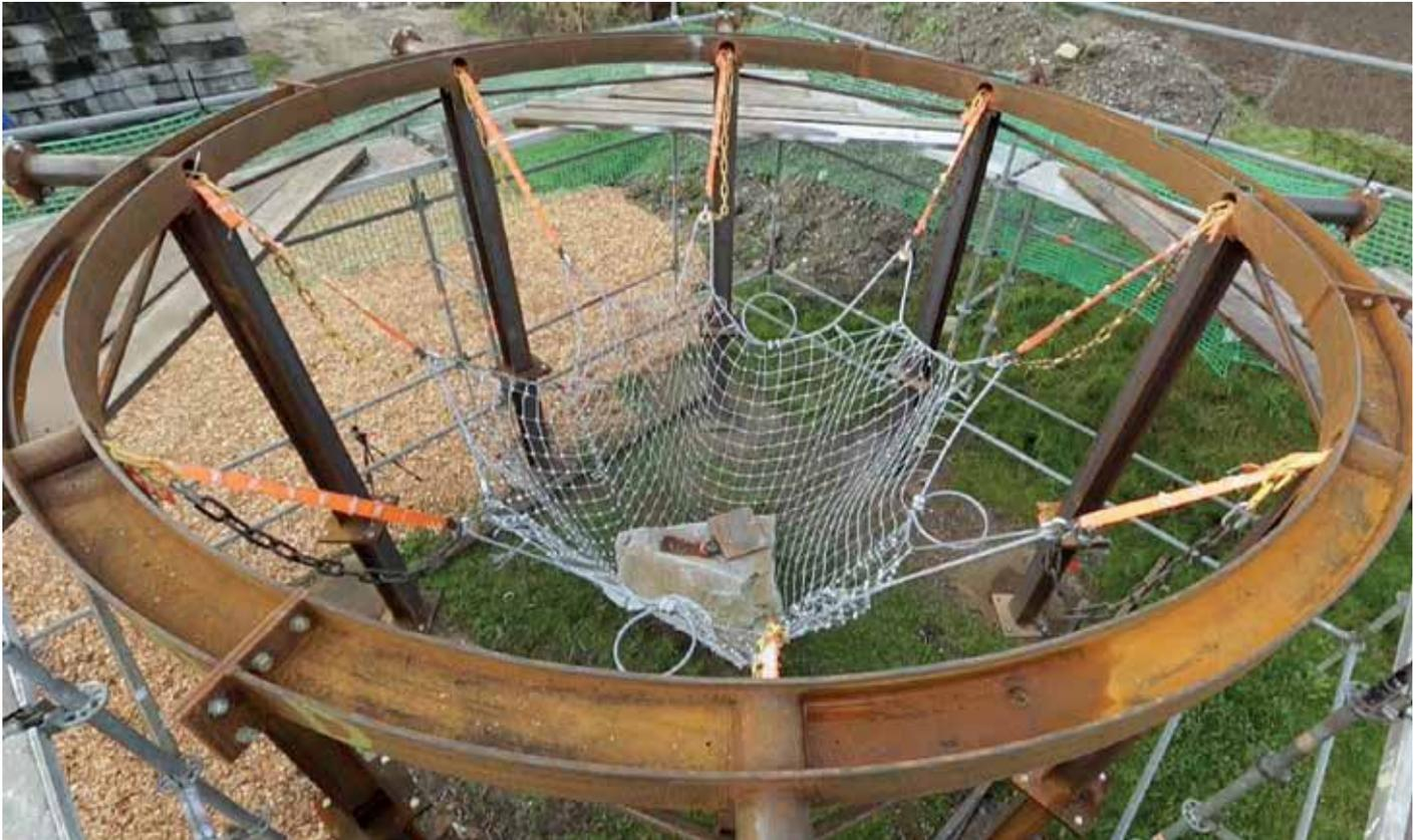
Bei den Fallversuchen wurde die Prüfmasse aufgefangen ohne sicherheitsrelevante Beschädigungen des Netzes oder der Dämpfersysteme
