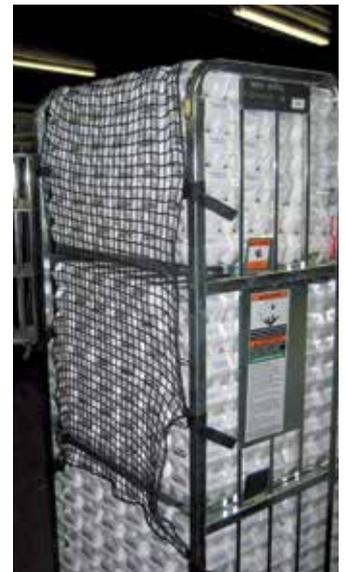
Sicherungsnetz aus elastischem Netz Tuch
