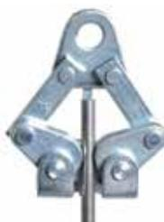
**Froschklemmen Typ FKS**, zum Spannen und Ziehen von Rundstahl (Nadeln). Extra stark, **Spann-Ø 10-25 mm**, Bruchlast 3 t, Zugkraft 1,5 t, verzinkt, mit gehärteten Stahlbacken und übergreifender Klaue mit Führung, Gewicht 2,55 kg. Für den Einsatz in der Baubranche, vor allem im Tiefbau-Bereich. Typ FKS Art.-Nr. 14570100 Stück € 135,00
